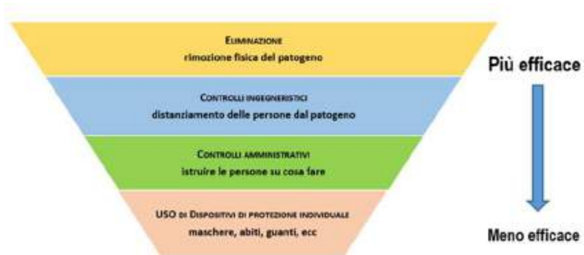
Figura 2. Gerarchia di controllo per la riduzione del rischio di trasmissione aerea del SARS-CoV-2 (36)
